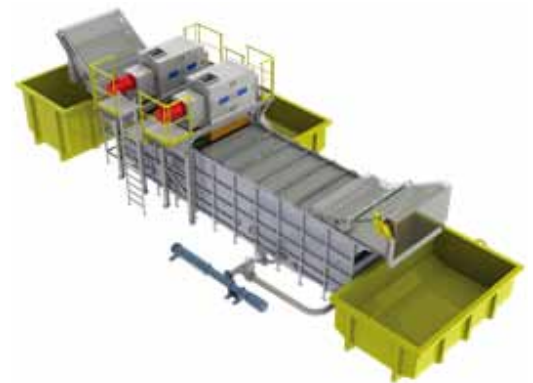
ADOS Mill + SEDImentation Tank
